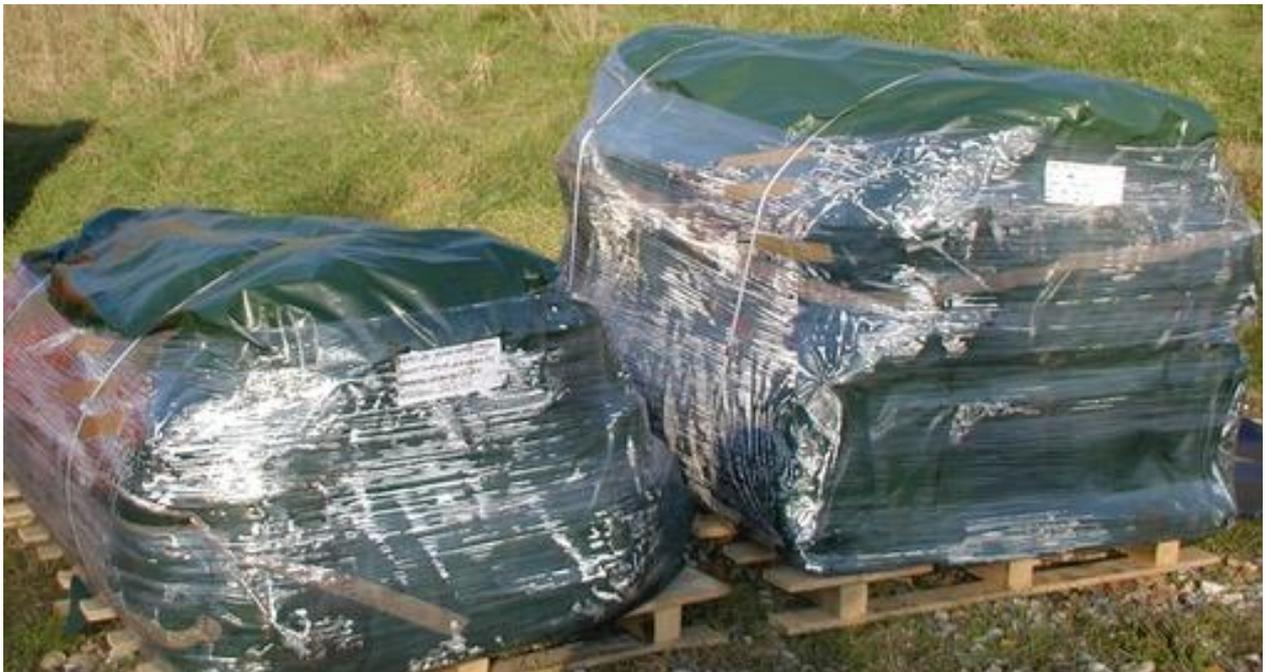
Figure 1. Préfabrication jusqu'à 5 000 m<sup>2</sup> /nappe
